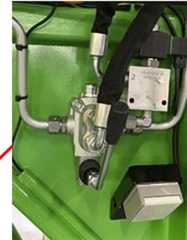
Ventil: **1002042KVK\*** (Heckklappe)
